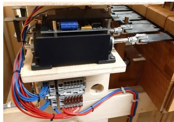
Schleifenzugmagnete, von denen jeder bei Betätigung seiner Registertaste am Schalttableau die entsprechende gelochte Schleife unterhalb der Pfeifensitze für dieses Register so verschiebt, dass Luft von unten aus den jeweils bespielten Tonkammern nach oben in die dann jeweils tönenden Registerpfeifen strömen kann.
