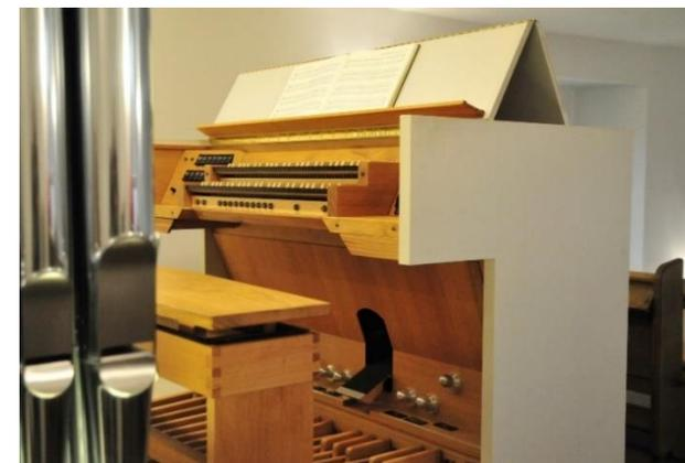
*Der Spieltisch der Orgel mit zwei Manualen und einem Pedal, dem Schwell-Fußtritt zur Bedienung des Generalschwellers, den Fußstastern für die Setzeranlage und den Manual-Pedal-Koppeln, den Registerschaltern links neben den Manualen und mit den Programmierknöpfen für die Setzeranlage (Tastknopf-Reihe unterhalb der Manuale).*
